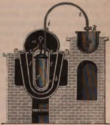
Fig. 118. — Appareil pour la préparation du phosphore amorphe.
